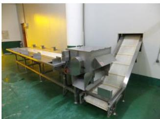
隧道式急速凍結設備
